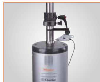
Kontrola pomocou páčkovej sondy (indukčná sonda)
