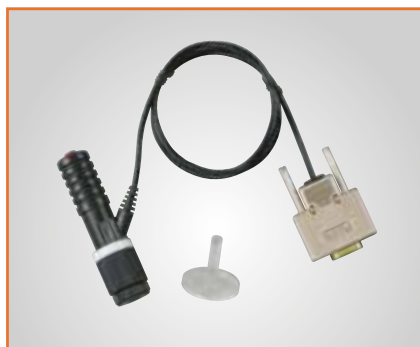
HLDC snímač nárazu UD-412 Použite pre vnútorné steny valcových otvorov. Používa sa na vnútorných stenách valcov, rukoväť je krátka, aby umožnila vnútorné umiestnenie.
