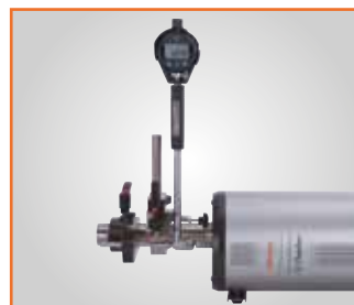
Kalibrácia s použitím súpravy príslušenstva pre dutinomer s odchýlkomerom (typ C)
