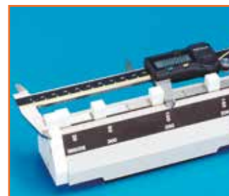
Kontrola presnosti posuvného meradla (vonkajšie meranie)
