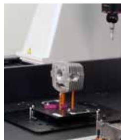
K551218: Příklad aplikácie upínacieho paletového systému
